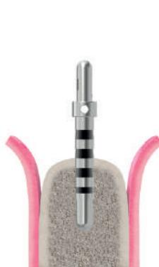
Vérifiez la profondeur du site chirurgical et l'axe d'insertion en insérant la Sonde/Paralléliseur Pilote 1 Réf. MUR201. Vous pouvez répéter cette étape autant de fois que vous le jugez nécessaire tout au long de l'intervention chirurgicale.
